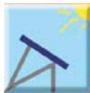
Schéma d'une structure de type console non éligible à la prime d'intégration au bâti
